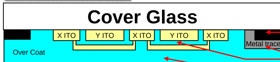
OGS方式タッチパネル断面図
